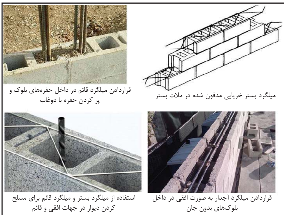
شکل پ.۴-۵- دیوارهای بنایی مسلح
